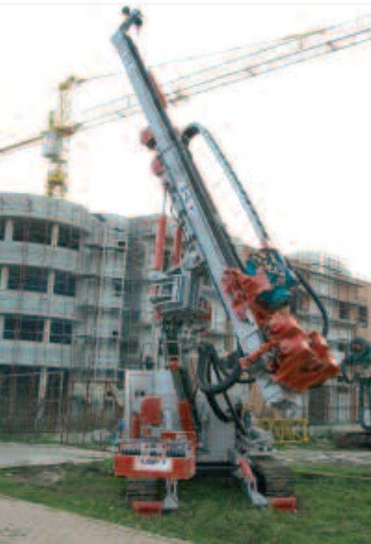
Sip&T produce tre modelli di perforatrici idrauliche cingolate per micropali, tiranti e ancoraggi: ST 550, ST 1050 e ST 1550
