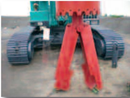
Varie le tipologie di bucket prodotti da Sip&T: con fondo piano, conico, doppio fondo, centrifughi, allargatori. Al centro un bucket da roccia e a destra uno per terra
