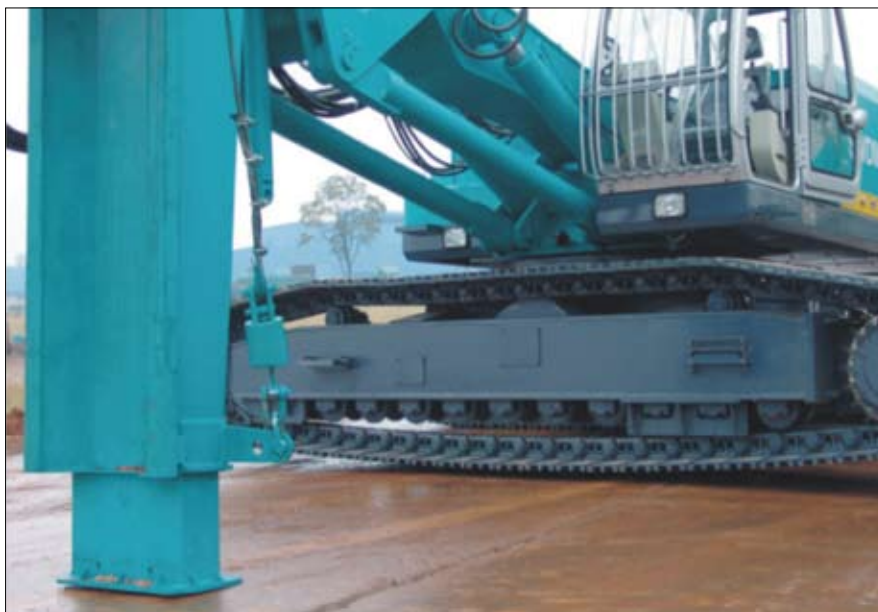
Il piede del mast è telescopico comandato idraulicamente
