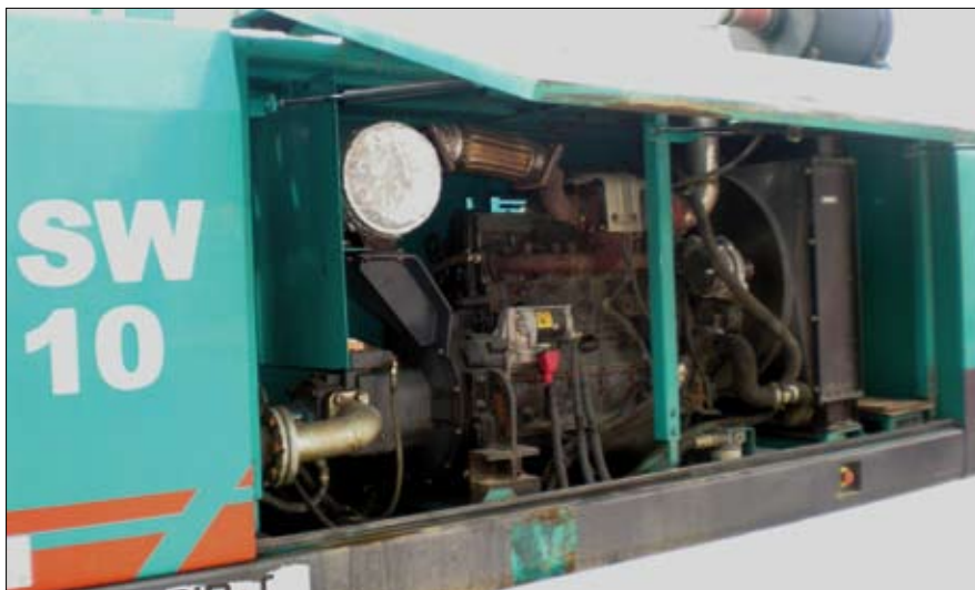
Il propulsore eroga una potenza di 164 kW a 2.200 giri/min e l'impianto idraulico è basato su una pompa principale della portata di 280 l/min e due pompe ausiliarie da 99 l/min di portata totale
