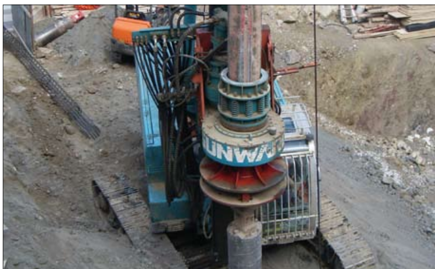
La rotary è dotata di un sistema ammortizzante per attutire le elevate sollecitazioni sviluppate dal kelly bar
