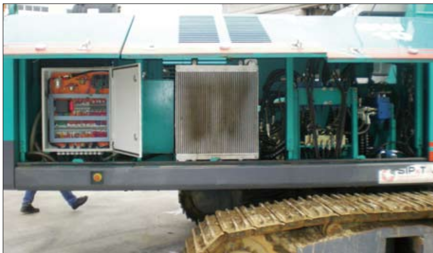
Il lay-out della macchina è molto ordinato e privilegia la massima accessibilità dei componenti e una facile manutenzione
