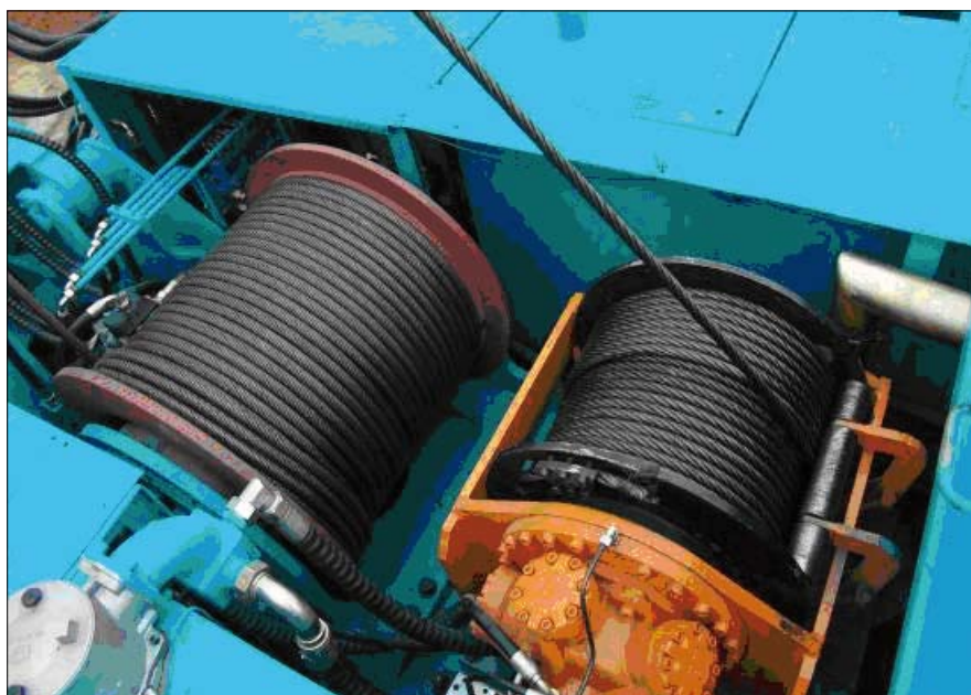
La vasca argani. La forza di tiro sviluppata è di 115 kN
