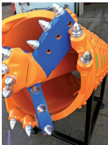
Particolare del carotiere Tri-Lama utilizzato per rocce aventi valori di resistenza a compressione compresi tra 50 e 100 MPa.
