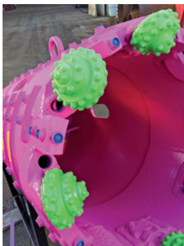
Particolare del carotiere Roller Bits utilizzato per rocce aventi valori di resistenza a compressione superiori ai 100 MPa.
