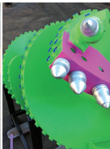
Particolare dell'elica da roccia utilizzata per rocce con valori di resistenza a compressione compresi tra 12.5 e 50 MPa.
