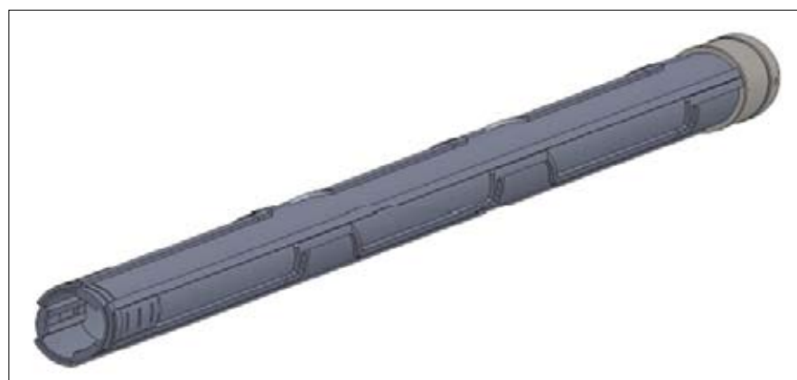
Modello solido realizzato con un CAD 3D parametrico che rappresenta il dominio di calcolo dell'analisi FEM
