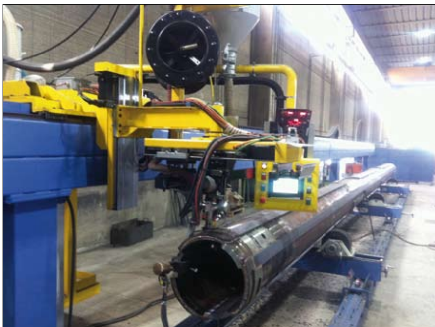
Processo automatizzato di saldatura ad arco sommerso dei kelly bar
