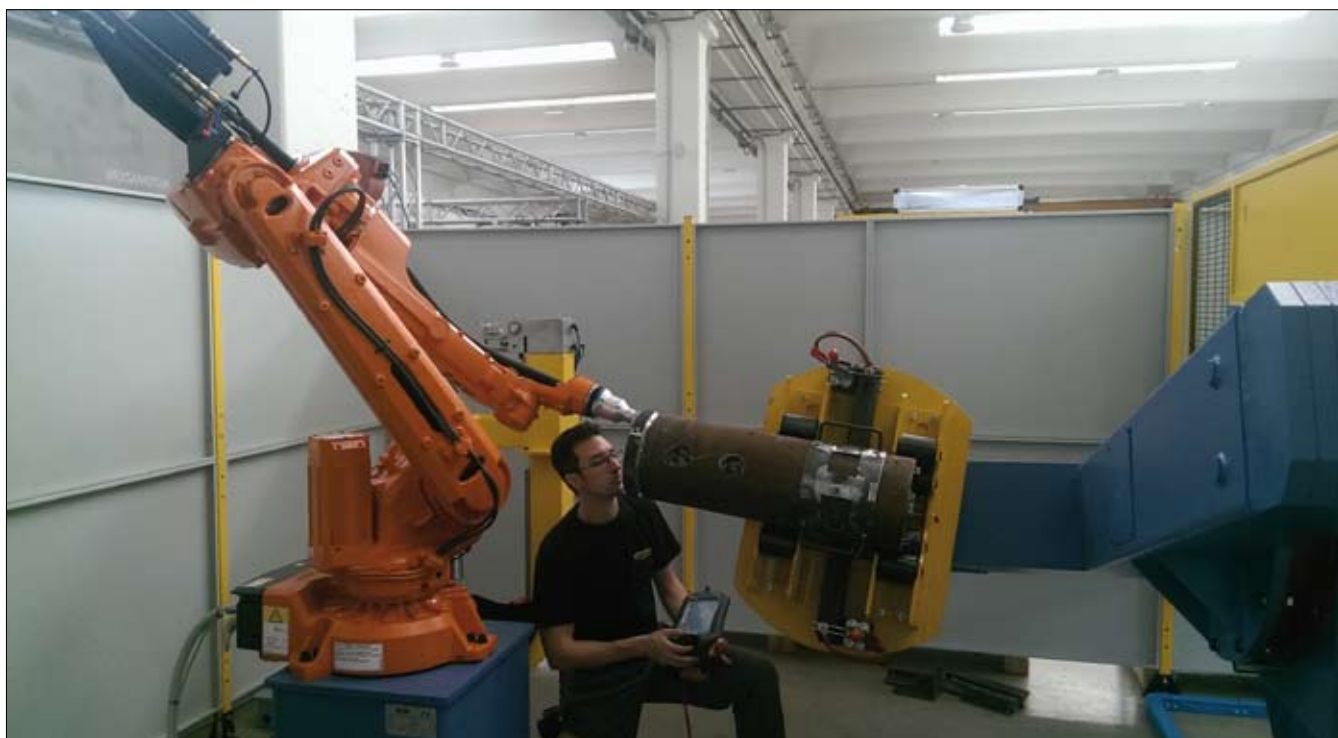
Robot di saldatura per i terminali dei kelly bar
