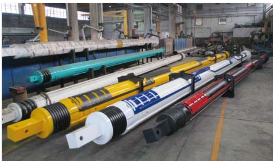
Kelly bar per trivelle con coppia tra 200 e 390 kNm, tra 160 e 320 kNm e tra 140 e 460 kNm
