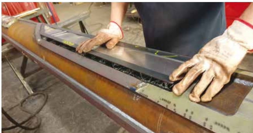
▲ SISTEMA D’INSONORIZZAZIONE DEI KELLY BAR CON GOMMA BUTILICA SUPER ADESIVA IN LEGA DI ALLUMINIO. LA MEDIA DI DECREMENTO DEL RUMORE A 70 MPH È DI 5,37 DB
