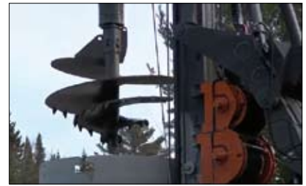
Conical Rock Auger OD 2,6 m - SHD type
